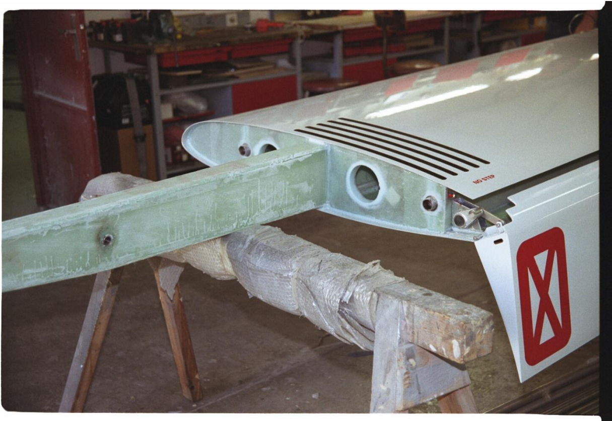
Kuorirakenteinen lujitemuovista valmistettu siipi (TL Sting). Kuvassa vasemmalla näkyy laatikkomuotoinen pääsalko ja oikealla puolella laskusiiveke. © Nils Rostedt
