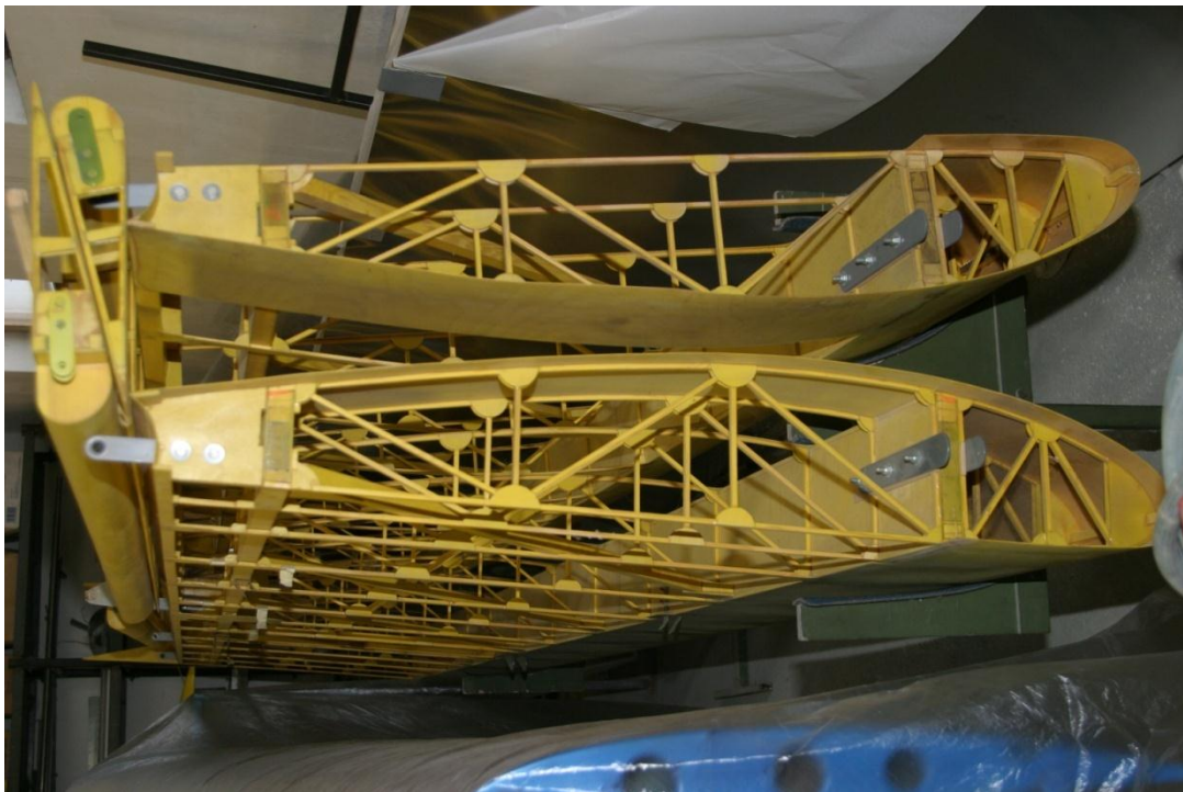
Puolikuorirakenteinen puusiipi. Se osa siipeä, joka alkaa pääsalosta ja päättyy etureunaan (kuvassa vasemmalla puolella), muodostaa putkimaisen ns. torsio-osan. Torsio-osa on vanerilla päällystetty ja antaa siivelle vääntöjäykkyyttä. © Nils Rostedt
