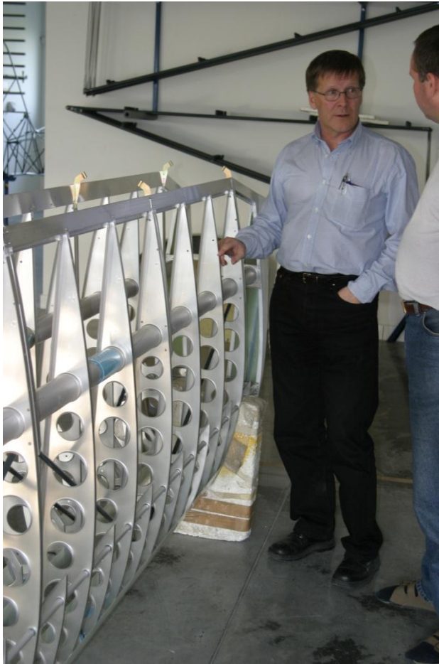
Metallirakenteinen siipi (puolikuorirakenne, ultrakevyt Eurofox) © Nils Rostedt
