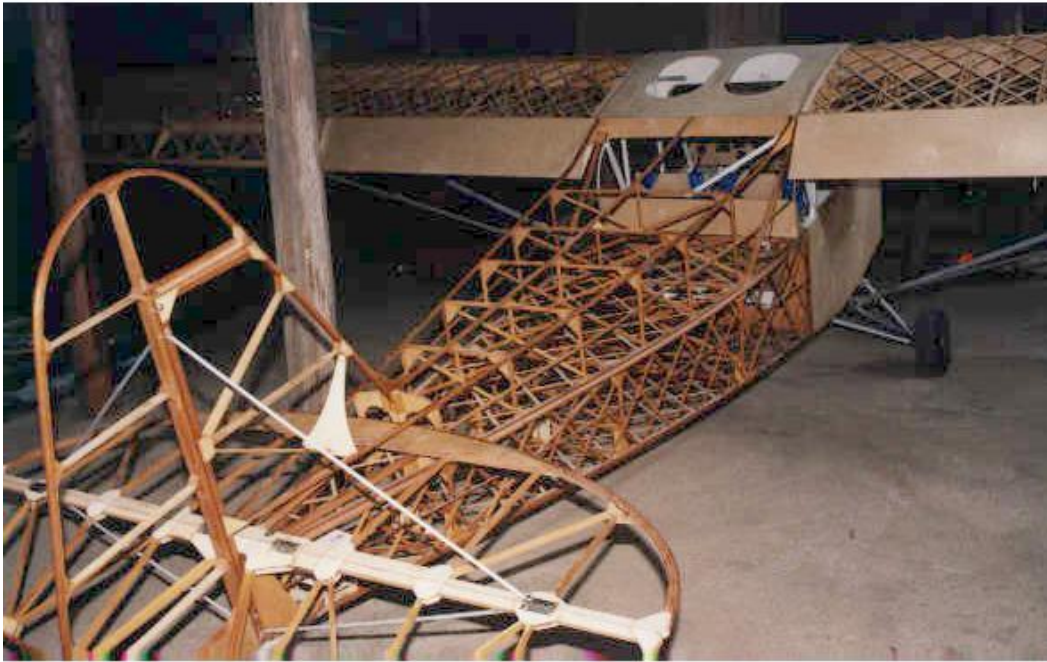
Super Koalan runko koottuna. Kone edustaa pääosaltaan puusta liimattua ristikkorakennetta. © Markku Salminen 2008
