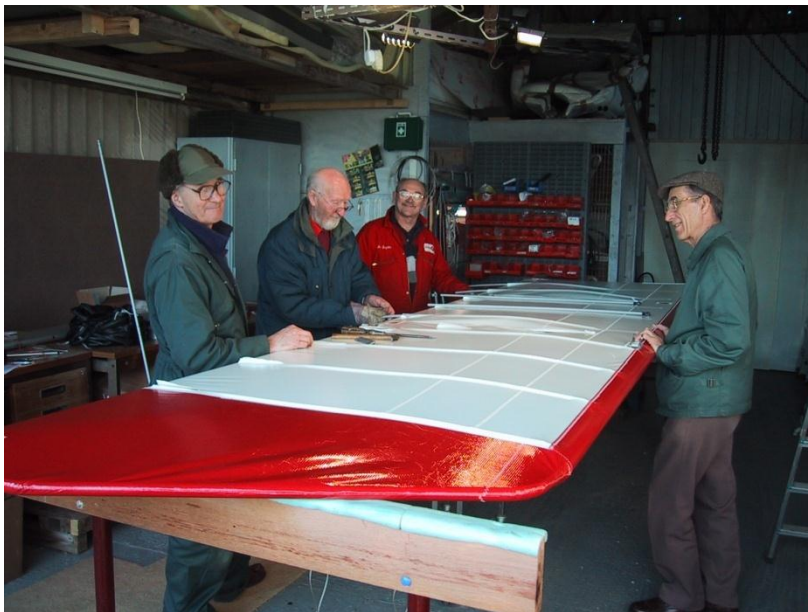
Siiven päällystysvaihe menossa jolloin valmis siipipussi pingotetaan kootun "kehysten" päälle. Siipikaaret pujotetaan siipikankaan sisäpuolella oleviin ommeltuihin taskuihin ja lukitaan paikoilleen. © Alan Whitlock
