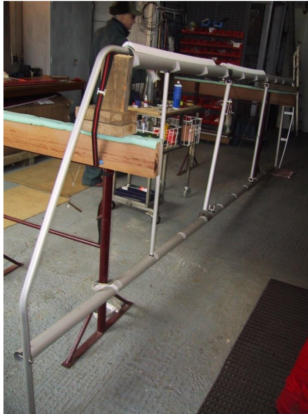
Sekarakenteisen siiven kokoonpanon ensimmäinen vaihe, salkoputket ja poikittaiset putket kiinnitettyinä. Siipikaaret puuttuvat vielä. © Alan Whitlock
